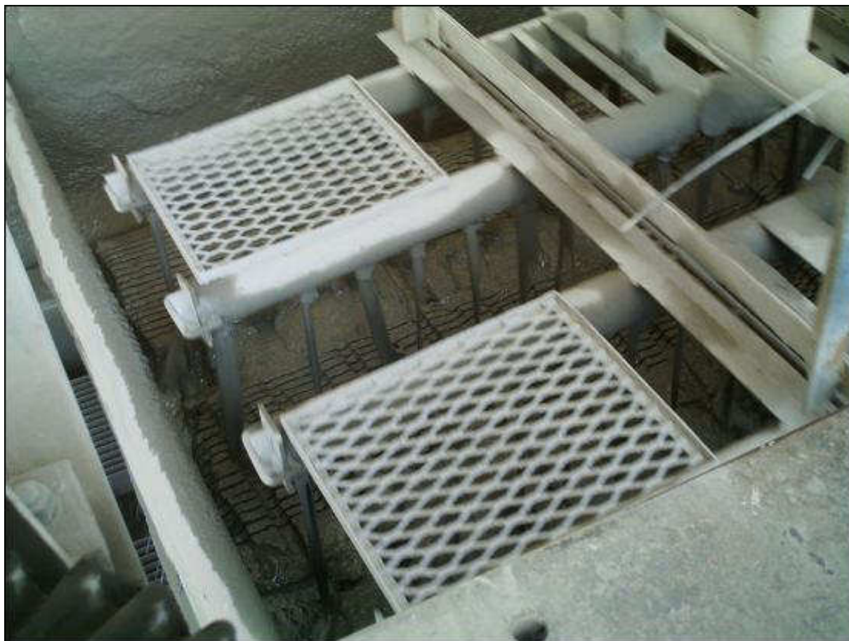
Foto 08: Tear em ação, cortando em placas um bloco de granito na região do Córrego do Itá, Barra de São Francisco – ES. Em média cada bloco é serrado em 24 horas.
