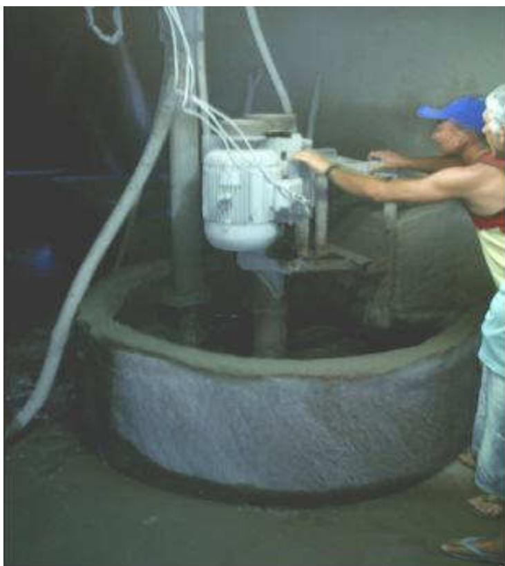
Foto 11: Depósito de resíduos sólidos (pó de granito e resto de granalha empregada na serragem), recolhidos de um tear localizado na micro-bacia do Córrego do Itá, Barra de São Francisco - ES. Fonte: POUBEL, 2006.
